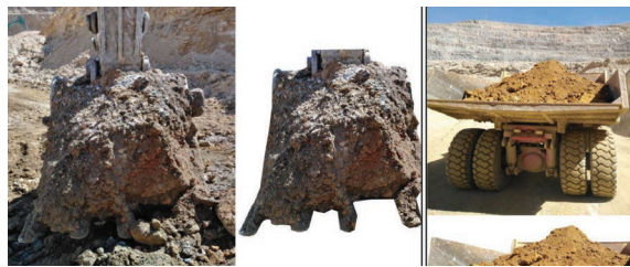
شکل ۷- عکسبرداری از مواد خرد شده در داخل جام شاول (چپ) و بار کامیون (راست)
